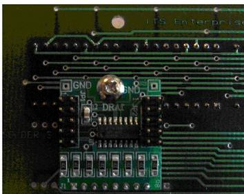
**J1** – Segment buss connector pin 1 – D0...pin 8 – D7
